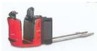
Carrello commissionatore elettrico a basso livello di prelievo: ne esistono anche a medio (fino a 5 m di altezza) ed alto 10 m
